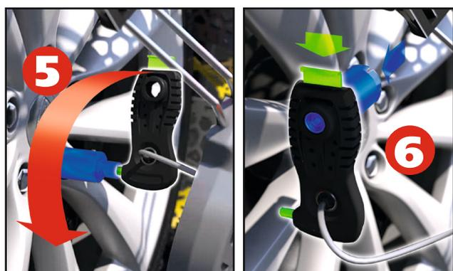
5 Desserrer l'écrou universel à l'aide de la clé 6 pans.
